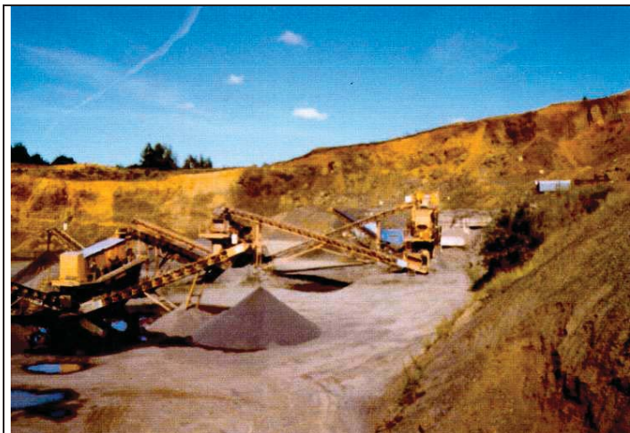
Foto č. 7: Ddrcení a třídění kameniva na lince Wageneder
